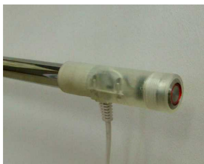
図 1 電源部の光造形モデル
