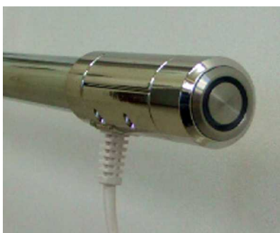
図 2 電源部のメッキ処理モデル
