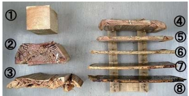
第8図 熱圧処理後の断面形状 ①無処理，②常温，③100℃，④120℃，⑤140℃，⑥160℃，⑦180℃，⑧200℃ Fig. 8. Cross-section surface after hot pressing. ① Untreated，② Room temp. ③ 100℃，④ 120℃，⑤ 140℃，⑥ 160℃，⑦ 180℃，⑧ 200℃
