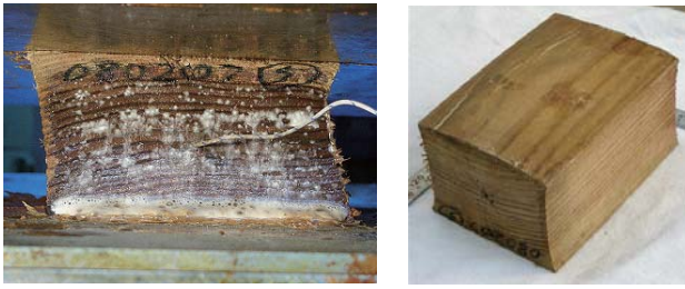
第5図 圧縮力が不足した場合の変形状況 Fig. 5. Deformation under insufficient compression.
