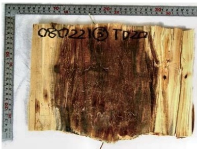
第3図 気乾材を原料とした熱圧処理材 Fig.3. Deformation treatment of air-dried wood.
