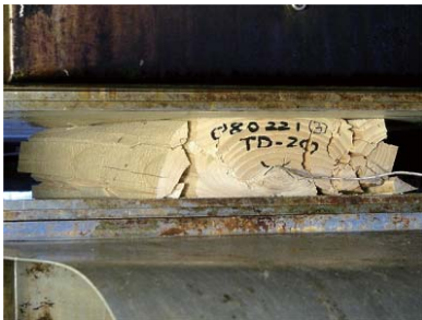
第2図 気乾材の圧縮時に生じた破壊 Fig. 2. Destruction of air-dried wood by compression.
