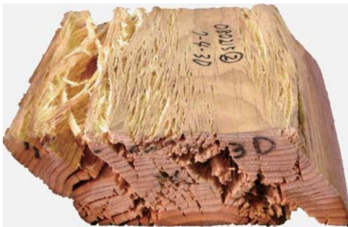
第6図 常温圧縮し幅拡張後に解圧した例 Fig. 6. Deformation without heating.
