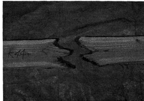
写真5-2 カラマツの引張り破断の例
