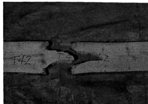
写真5-4 トドマツの引張り破断の例
