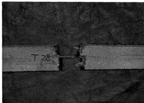
写真5-3 トドマツの引張り破断の例
