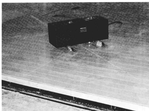
写真 床衝撃音レベルの測定
