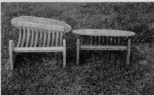
第1図 無処理 (左) およびMG処理 (右) ベンチの屋外暴露試験結果
