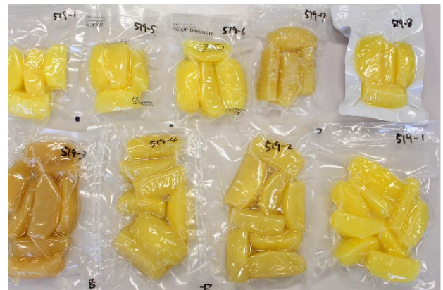
図3-1-1-8-1 15°C保管中のパウチ材質毎の色調
