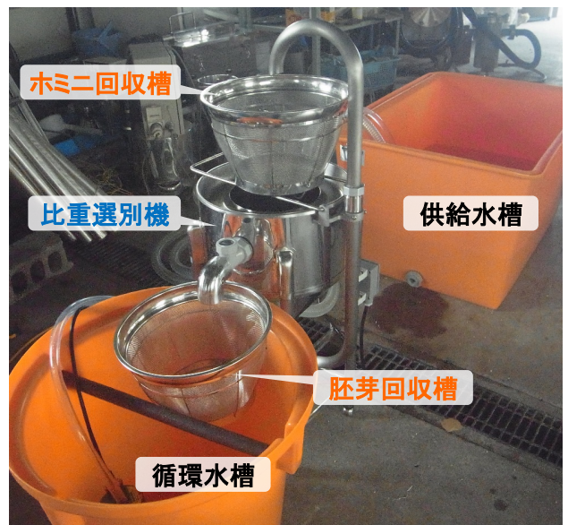
図5-1-4-13 開発した胚芽分離回収装置の外観
