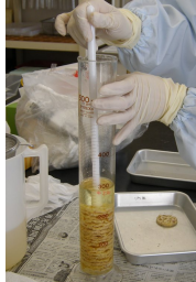
図5-1-1-11 膨化性測定方法の概要
