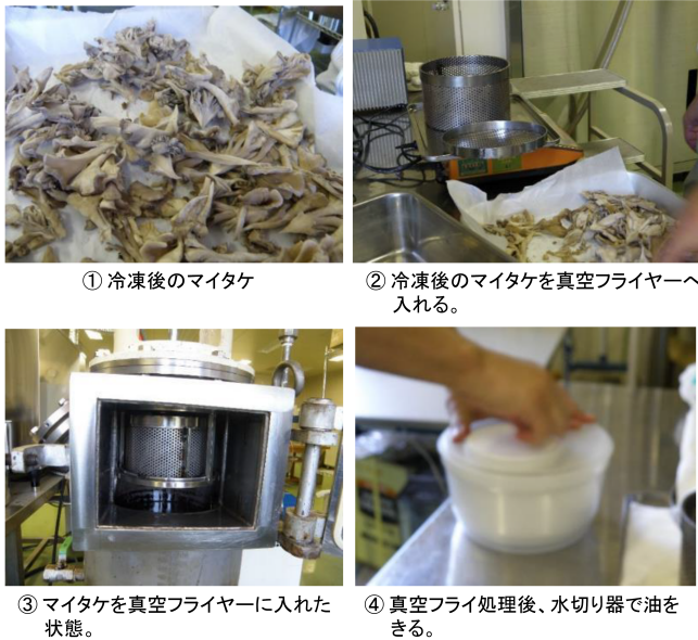
図6-5-14 冷凍後のマイタケの真空フライ処理
