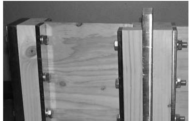
第5図 接合部で破壊した試験体の一例
