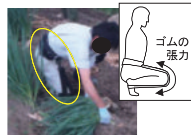
下肢サポータ (移動時の大腿の引き上げ補助 膝着き姿勢での背もたれ効果)
