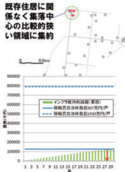
図 3-1-7 上五区集落における集約方法別将来インフラ削減額と移転費用の比較（円状集約）
