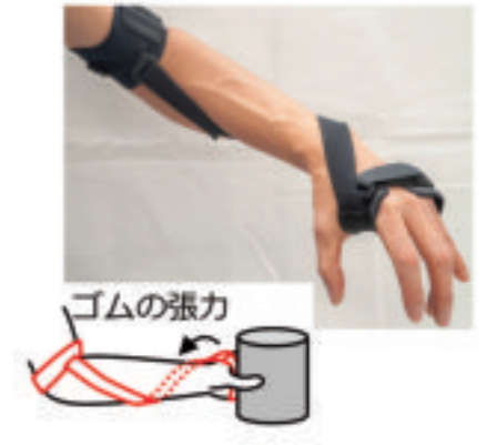
↑ 図3 前腕サポータ 把持物体の重量に対抗する方向にゴムの張力が働くことで前腕の筋負担を軽減
