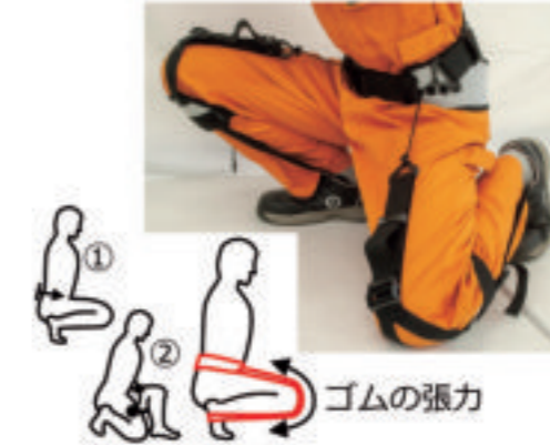
↑ 図2 下肢サポータ ①膝を前に突き出した姿勢における背もたれ効果 ②しゃがんだまま移動する際、大腿の引き上げを補助
