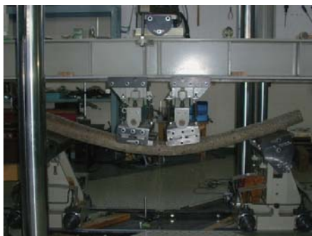
第1図 曲げ強度試験 Fig. 1. Bending test.
