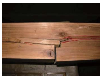
第 13 図 目違い部からの割裂破壊 Fig. 13. Splitting failure at notch (okkakedaisen-tsugi joint).
