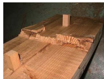
第 12 図 あご面の圧縮破壊 Fig. 12. Compression failure of ago-face (okkakedaisen-tsugi joint).
