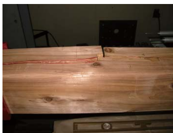
第 11 図 せん断破壊 Fig. 11. Shear failure of beam (okkakedaisen-tsugi joint).
