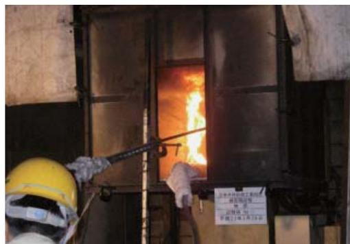
第 12 図 加熱中の供試箱の状態 (処理材 B)
