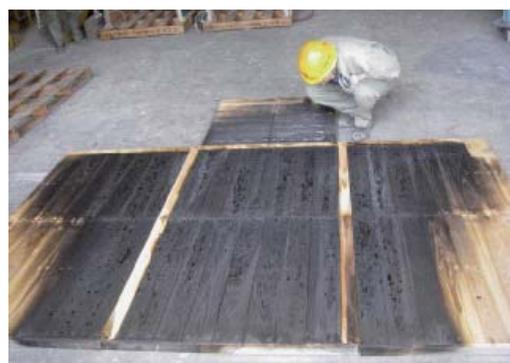
第 13 図 加熱終了後の構成パネルの状態 (処理材 B)
