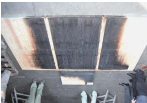
第 10 図 加熱終了後の構成パネルの状態 (処理材 A)
