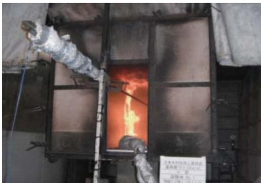
第 9 図 加熱終了時の供試箱の状態 (処理材 A)
