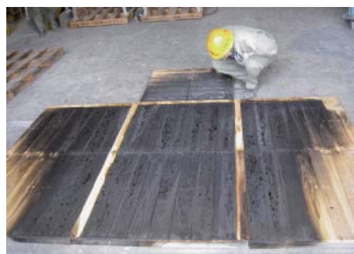
第 13 図 加熱終了後の構成パネルの状態 (処理材 B) Fig. 13. Appearance of component panel after heating (treated sample B).
