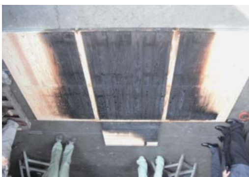
第 10 図 加熱終了後の構成パネルの状態 (処理材 A) Fig. 10. Appearance of component panel after heating (treated sample A).
