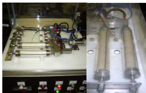
写真5-5-1 通電加熱（ジュール加熱）装置
