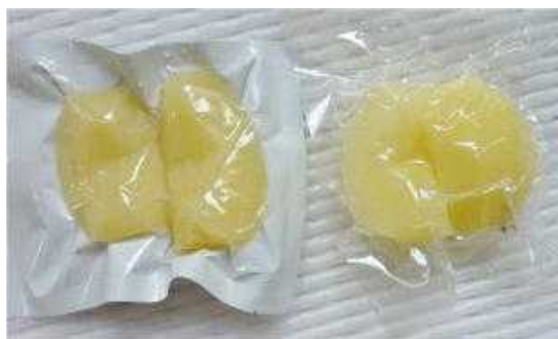
エージレスオーマック I B フィルム (酸素バリア+脱酸素) (酸素バリア) 写真 4-3-4 酸素バリア性および脱酸素性パウチ
