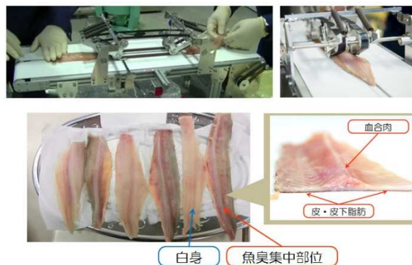
図 5-2-17 皮・血合肉同時除去装置(試作 2 号機)の試験の様子
