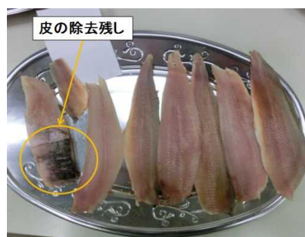
図 5-2-13 皮・血合肉同時除去装置(試作1号機)による除去試験結果
