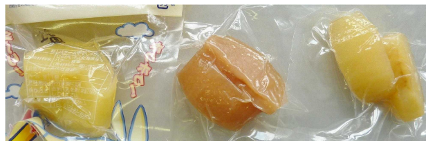
常温保存 常温保存 冷蔵保存 酸素バリア性 酸素バリア性なし 写真 4-3-3 パウチの酸素バリア性の有無による 果肉の褐変程度の違い (りんご「きたろう」, 加工3ヶ月後)
