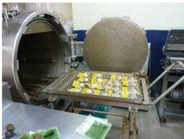
写真 4-3-1 使用したレトルト釜 (由仁町 喜井ファーム)
