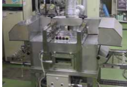
図 4-4-2 過熱水蒸気処理装置外観
