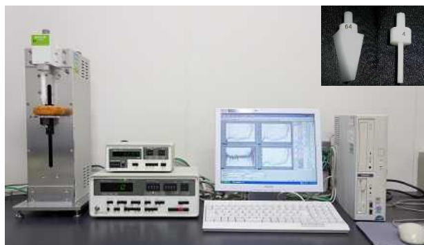
図3-4-1 破断試験に用いたレオメータおよびプランジャー (図中右上)
