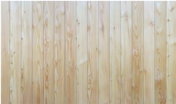
図4-1-3-4 カラマツの生節：死節の割合が100：0のもの
