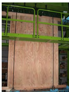
(a) タイロッド式・カラマツ合板 (b) 柱脚固定式・トドマツ合板
