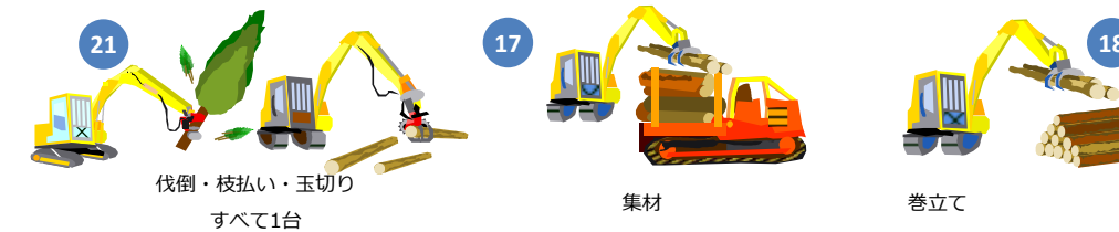
図 5-3-2-18 主伐試験区（石狩市）において実施した機械作業システム
