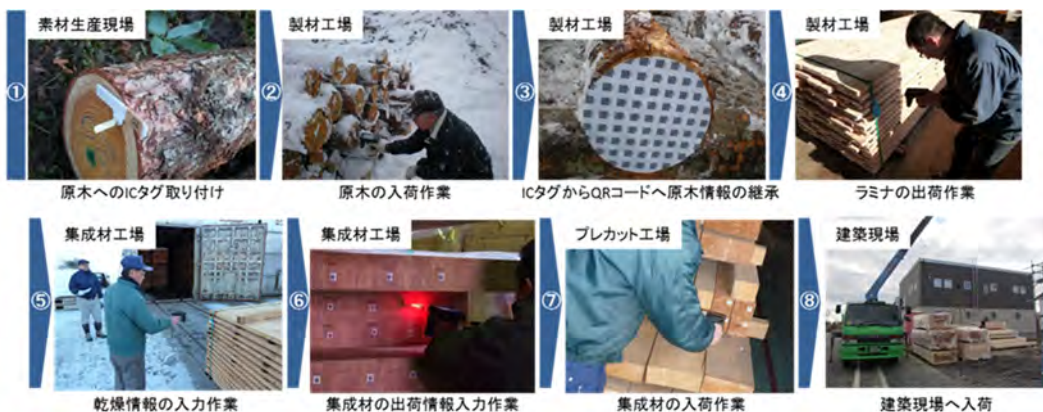
図5-2-2-2 木材トレーサビリティシステムの試行検証作業
