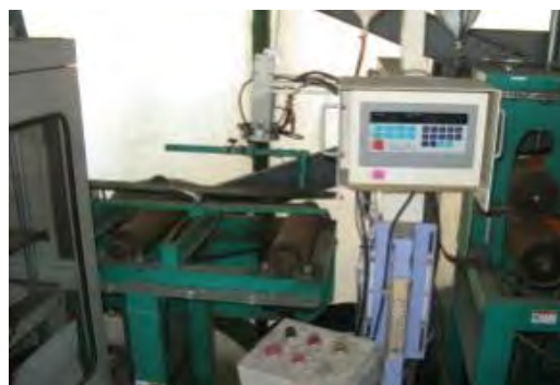
図 5-2-5-5 高周波式含水率計 (含む搬送・積み取り装置)
