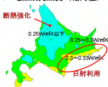
図2-1-2-5 外皮の平均熱貫流率の目安
