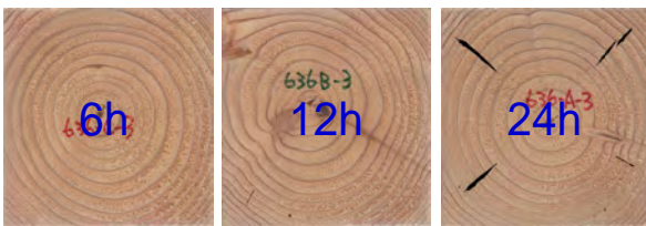
図4-1-1-8 高温乾燥時間と発生した内部割れ (乾球温度120°C・湿球温度90°C)
