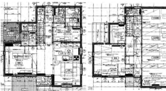
戦略研究 戸建て住宅モデル 外壁178㎡、屋根60㎡、窓30㎡(南16.3㎡)、基礎35m 気象データ: 拡張アメダス帯広標準年 全室暖房、居間7~23時22°C、それ以外居室20°C設定 3人家族、内部発熱12.1kWh/day
