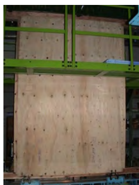
(a) タイロッド式・カラマツ合板 (b) 柱脚固定式・トドマツ合板
