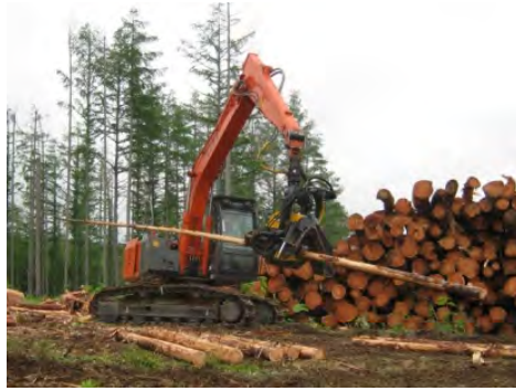
図5-3-2-1 玉切りするハーベスタ（高性能林業機械）
