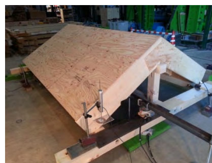
図2-2-3-4 5寸勾配屋根の水平耐力実験実施状況
