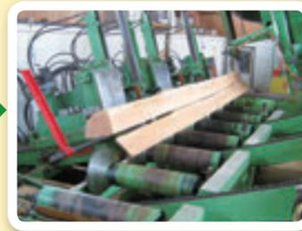
挽き材面の繊維傾斜を測定することにより、ねじれの小さいものを選択。
