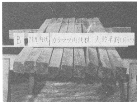
写真2. 耳付平割乾燥 正割 (11月間伐材, B条件)
