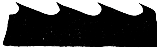
ピッチ: 39mm 歯高: 12mm 歯喉角: 30° 歯背角: 17° 歯端角: 43° 第1図 歯型の形状
