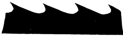
ピッチ: 39mm 歯高: 12mm 歯喉角: 30° 歯背角: 17° 歯端角: 43° 第1図 歯型の形状
