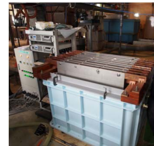
脱カドミウム 実証試験用電解装置
