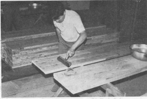
写真1. 積層ブロックの製造（接着剤塗布）
