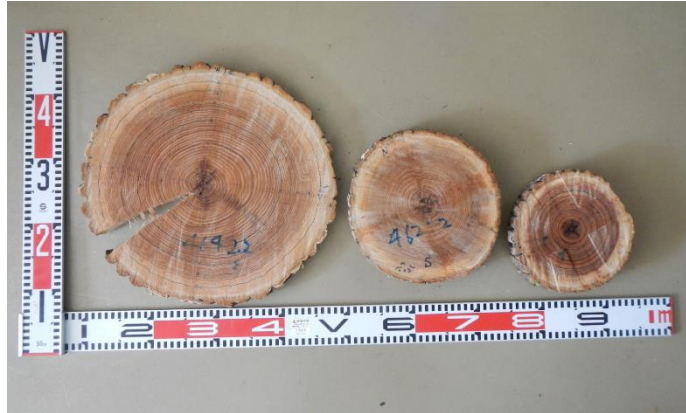
第3図 ヤチダモ試験木の地上高2.0mより採取した円板試料 (左から大径木、中径木、小径木)
