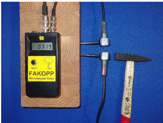
第2図 応力波伝播速度測定装置 Fig. 2. Fakopp Microsecond Timer
