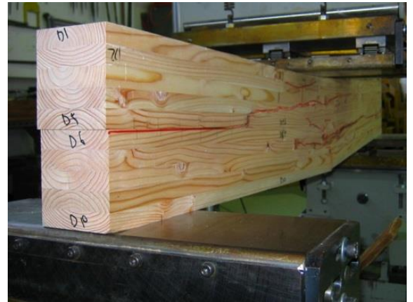
第12図 模擬はく離のせん断破壊 Fig. 12. Shear failure at simulated delamination.
