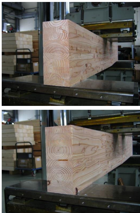
第13図 補修試験体の破壊状況
