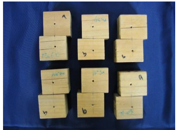
第6図 促進劣化処理後の試験片 Fig. 6. Test pieces after the accelerated deterioration treatment.
