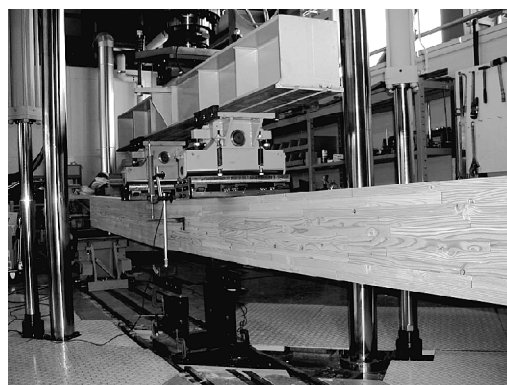
第2図 異樹種複合集成材の実大曲げ強度試験
