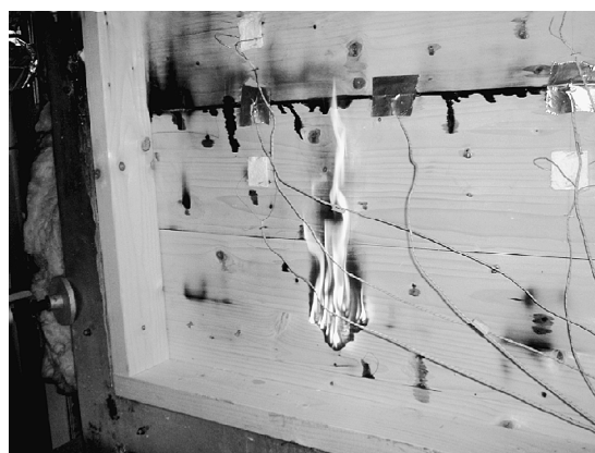
第2図 試作パネルの耐火試験（31分後）
