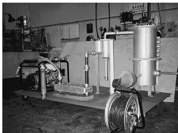
第 1 図 アップドラフトタイプのガス化炉
