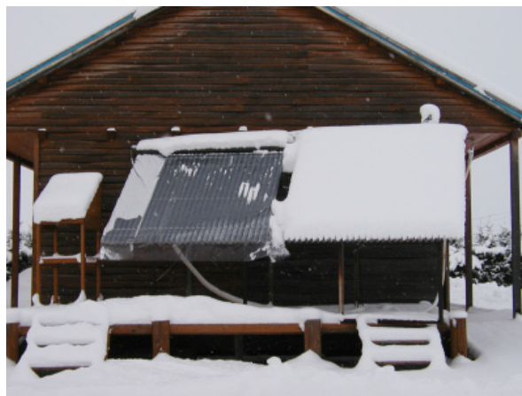
第 1 図 ビニルシート被覆による落雪促進効果 (左：ビニルシート被覆，右：15 年度に滑雪塗装)
