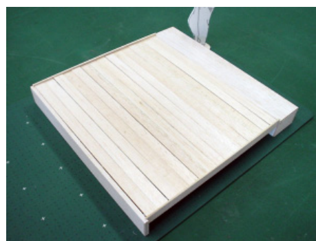
第2図 ボックス型収納式木製デッキ模型（展開時）
