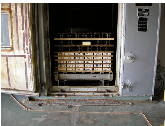
第 1 図 乾燥試験における棧積み
