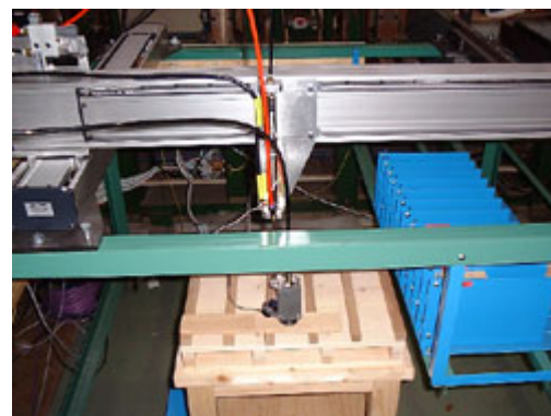
写真：動作確認用の棧積装置
