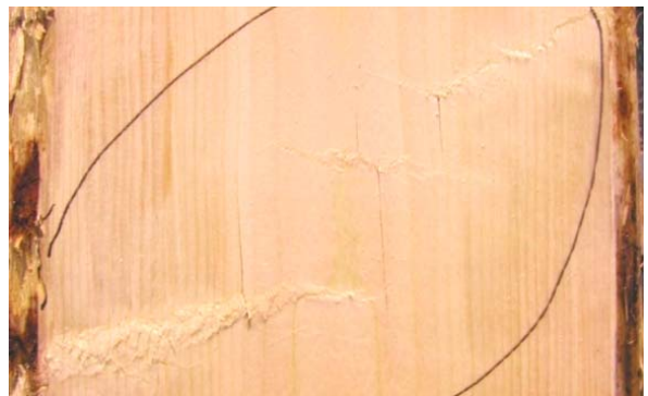
写真4 「もめ」の拡大図(トドマツ)
