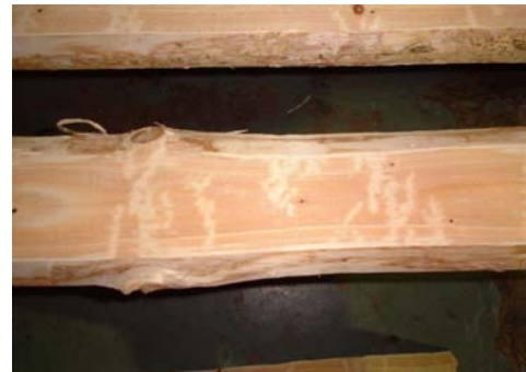
写真8 「もめ」と白色斑の混在例 （生材・トドマツ）
