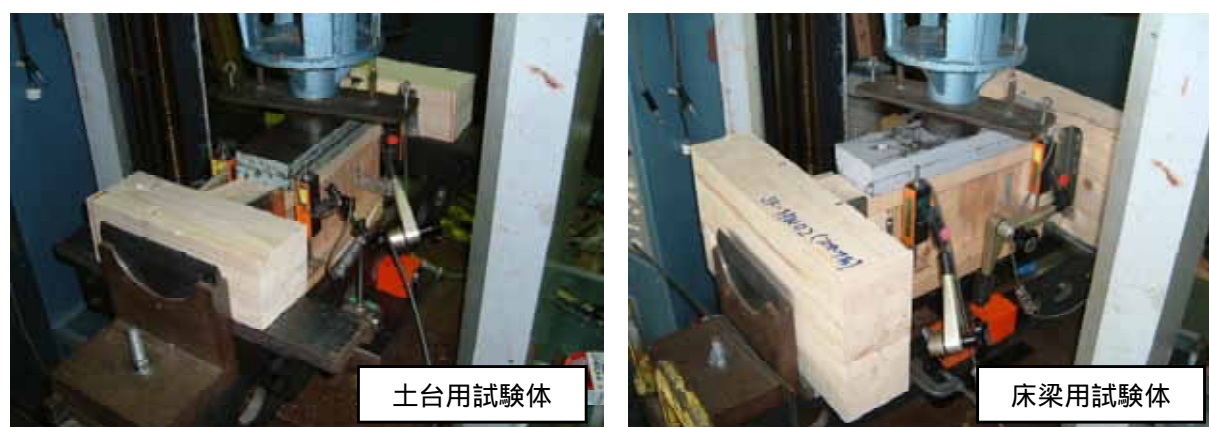
図1 金物せん断試験の様子
