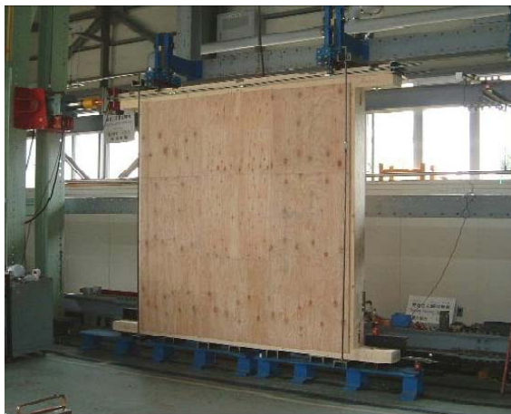
図7 面内せん断試験の様子
