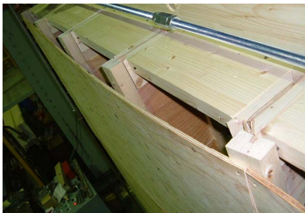
図17 ウェブの曲げ破壊(E3タイプ)
