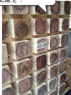
写真2 棧積みした材端部の様子
