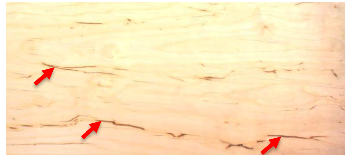
材面に現れた食害の痕（虫食痕）
