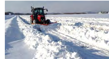
V羽根による雪割り（除雪）
