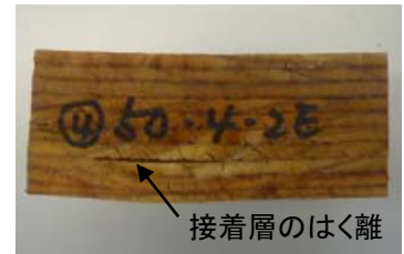
試験体のはく離の例
