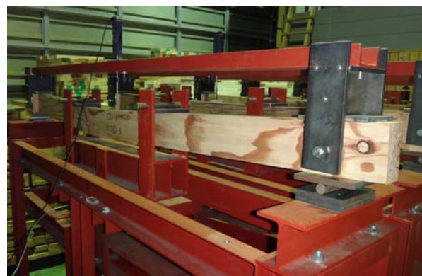
クリープ破壊の一例
