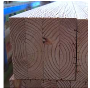
加圧注入処理の インサイジング加工
