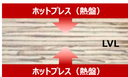
木材の断熱効果で熱が伝わりにくい
