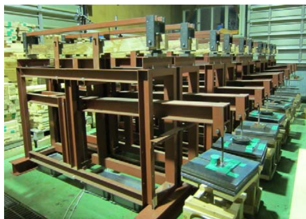
長期荷重試験の様子
