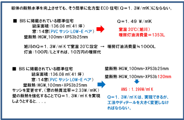
図3 高断熱化と暖房エネルギー消費量の関係 — 躯体の変更 —
