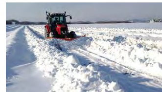
V羽根による雪割り（除雪）
