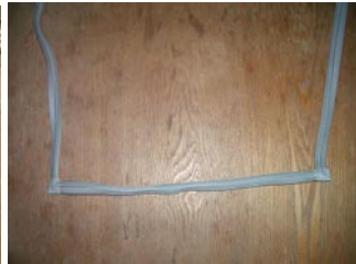
写真17 角を溶着した気密材
