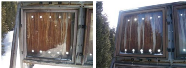
写真3 木製サッシの暴露試験 (浸透タイプ北面 15年目) 左：取付後再塗装無し 右：再塗装有り
