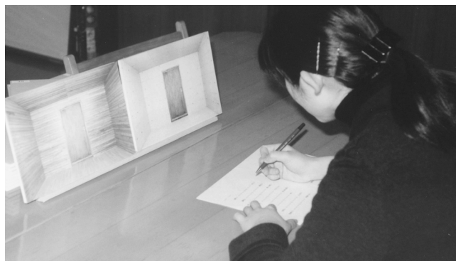
写真2 内装材のパネル試験
