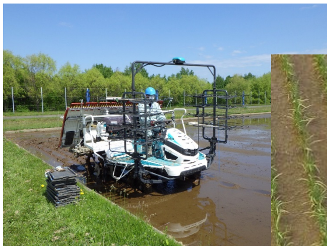
自動操舵田植機 (機体上部にGNSS受信装置がある)
