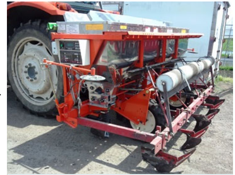
施肥マップ対応型作条施肥機 (サークル機工株式会社製)
