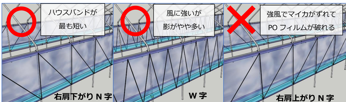
図 7-10 ハウスバンドの固定方法
