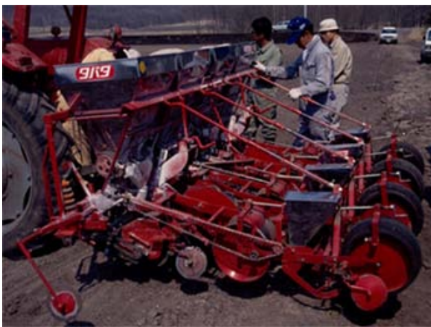
図 1-5 作条施肥混和ロータリ付き施肥播種機 （後部鎮圧輪は凸型）
