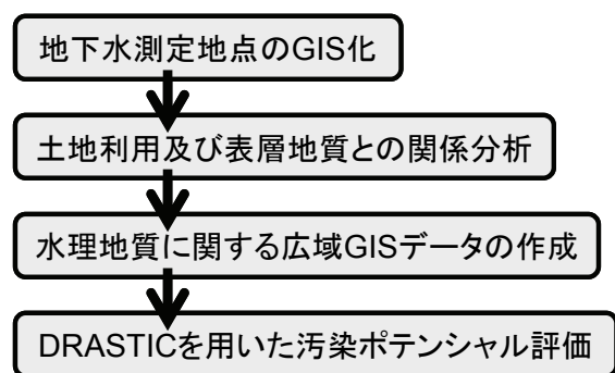
図 I-2-1 潜在的リスク評価研究のフロー
