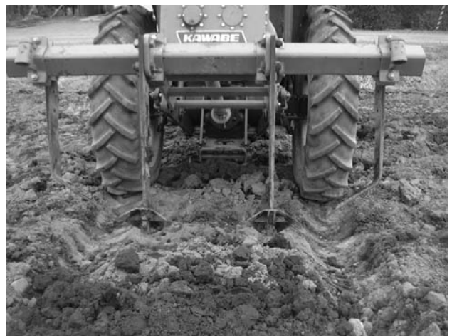
写真Ⅱ-1-1 振動式全層破碎機（カワベスーパーソイラーSV3）
