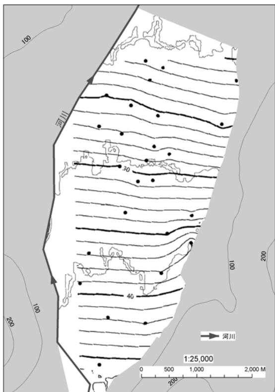
図 I-4-3 地下水面図 地下水面の等高線は 1m ごと。 ●は水位の測定箇所
