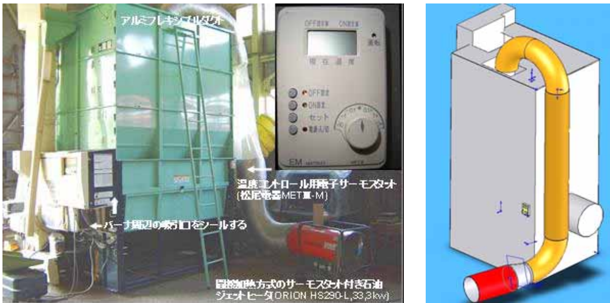
図1 循環式乾燥機上部から間接加熱式のジェットヒータで温風を送風する大豆の乾燥方法
