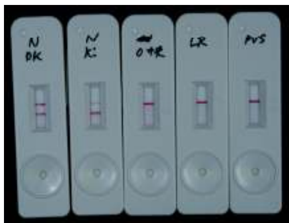
図2 ジャガイモYウイルスN系統のイムノクロマトキットによる検出
