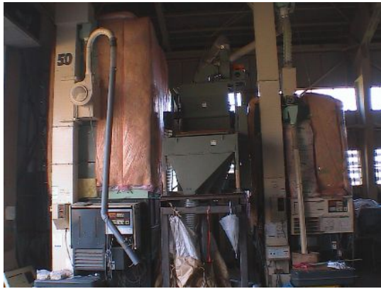
図1 断熱シートで被覆した米麦用循環式乾燥機 (左) と大豆・小麦混合貯留用の循環式乾燥機 (右)
