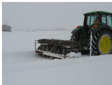
タイヤローラによる “雪踏み”作業の様子
